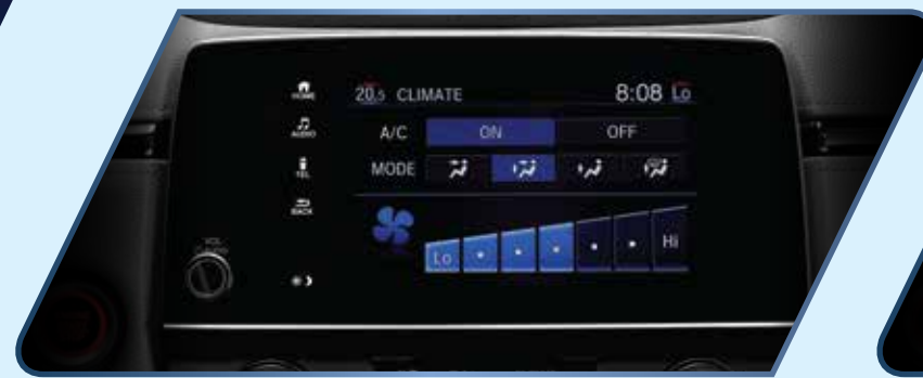
Hệ thống điều hòa tự động điều chỉnh bằng cảm ứng (L/G).
